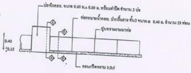
แบบขยายวางท่อคสล. พร้อมบ่อพัก SCALE 1 : 20
